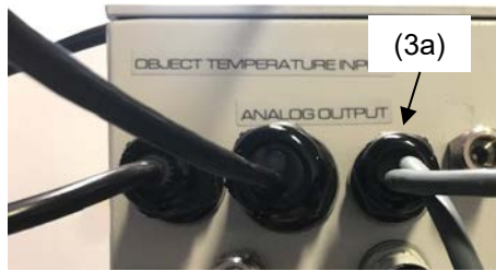
Abbildung 29: Anschlusskabel am Anschluss „Object temperature input“ (3a)
