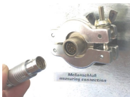
Abbildung 28: Messstutzen (12) mit Messstromdurchführung für Objekttemperaturanzeige
